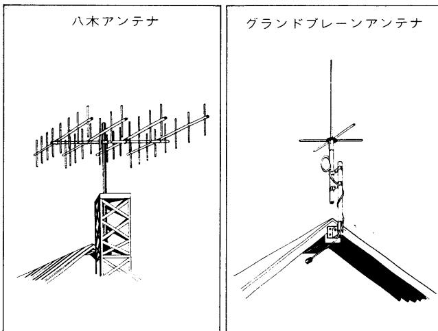
●本機のアンテナ整合インピーダンスは50Ωに設計されています。アンテナの給電点インピーダンスと同軸ケーブルの特性インピーダンスが50Ωのものをご使用ください。
