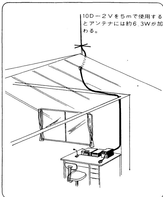
●アンテナの整合も極めて重要です。整合が悪いと損失が多いばかりか、極端な場合はトランシーバーにも悪い影響を与えることもあります。整合状態をみるにはSWR計を使用しますが、SWR計はUHF帯でも使用できるものをご使用にならないと異なった値を示すことがありますのでご注意ください。また、SWR計内部でも多少の損失が発生しますので、実際の運用時には取り外して運用してください。
