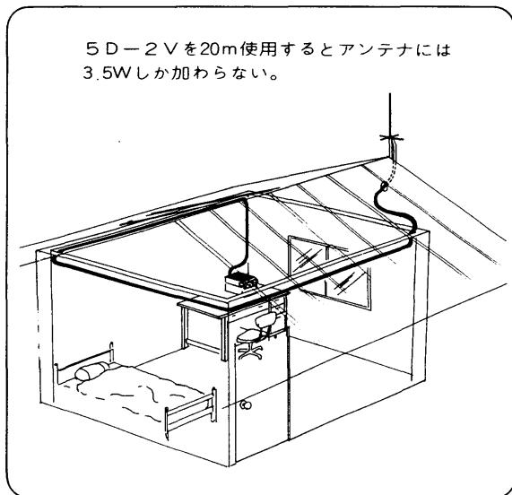
●同軸ケーブルには各種のものがありますが、できるだけ損失の少ないケーブルをできるだけ短かくしてご使用ください。
