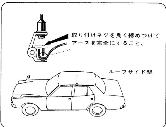
●同軸ケーブルは、ドアのすきまや窓などから車内へ引き込むことができます。但し、雨水が同軸ケーブルを伝って流れ込みやすいですでのご注意ください。
